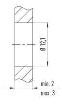
Anzugsdrehmoment/Tightening torque M12 x 1 1,00 Nm
